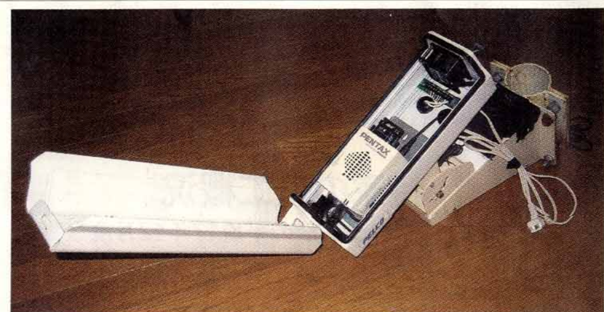
ハウジングケース内にライブカメラ本体を内蔵している
